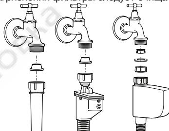
Закройте краны. Снимите гайки на заливных шлангах для доступа к фильтрам во впускных патрубках. Очистите их подходящей щеточкой. Если фильтры сильно загрязнены, их можно вытащить плоскогубцами и почистить. Извлеките фильтры из прямых концов заливных шлангов вместе с прокладками и тщательно промойте под струей воды. Аккуратно установите прокладки и фильтры на место и затяните гайки шлангов вручную.
